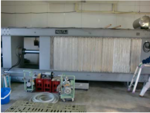
図 8 . 堤酒造藪田式濾過装置
