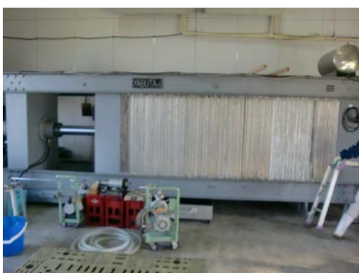
図2. 堤酒造藪田式濾過装置
