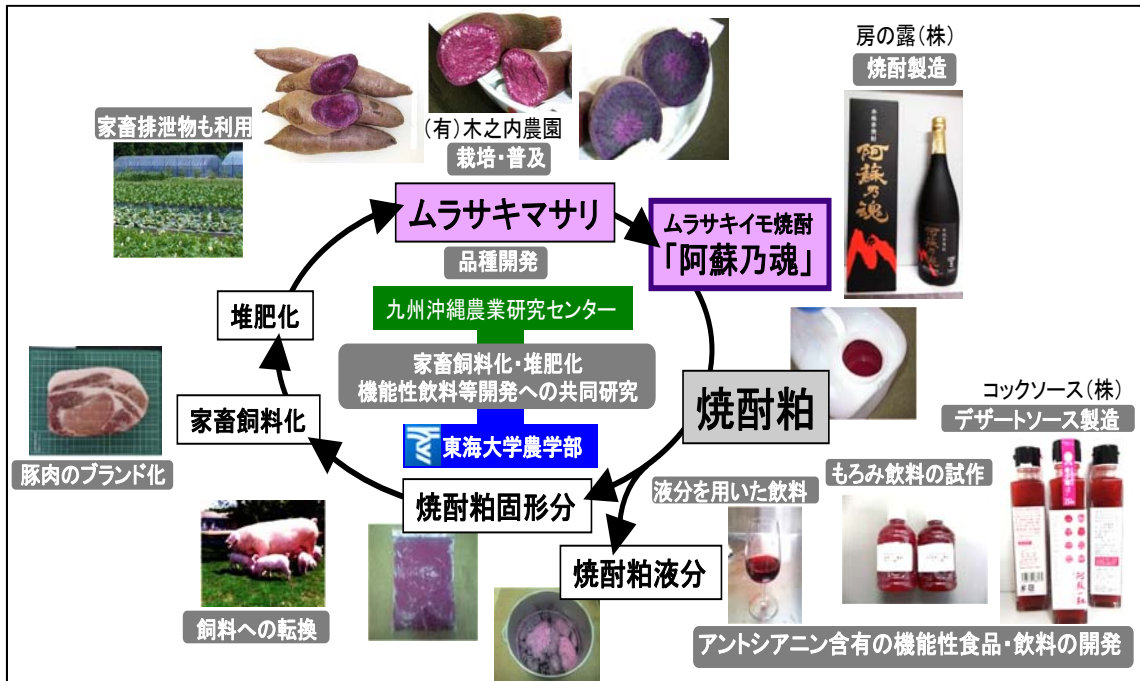
Fig. 11. 高アントシアニン含有イモ・ムラサキマサリを用いた高度循環型焼酎造りと焼酎粕有効利用（ゼロエミッション）の概念図
