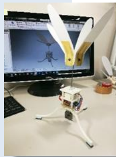
翅果を参考にした回転翼型飛翔体 Samara-based air vehicle with rotary wings
